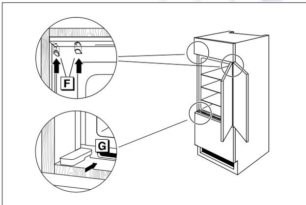
Соединить дверь прибора и дверь шкафа
